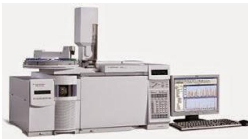
**Figure 4: GC Instrument<sup>[26]</sup>**
