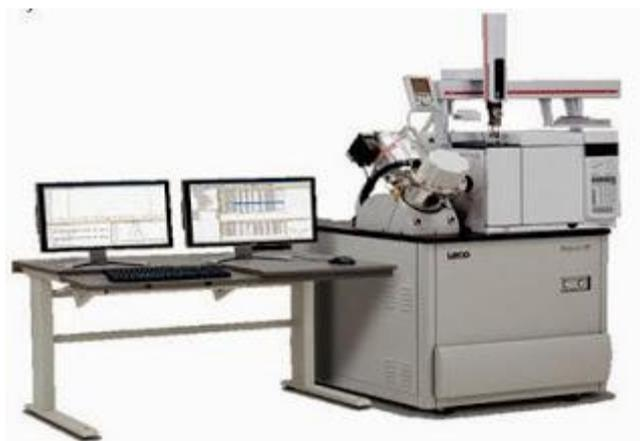
**Figure 2: GC/MS Instrument**<sup>[24]</sup>
